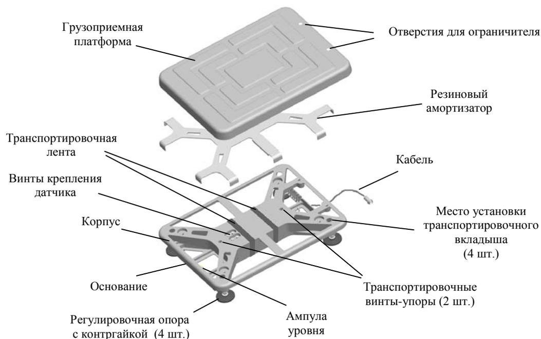
Рис. 4.1 – Модуль взвешивающий TB-S\_
